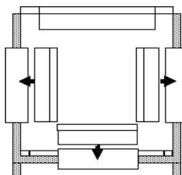
② 蓋をして、L型ホルダーを差し込み固定します。
