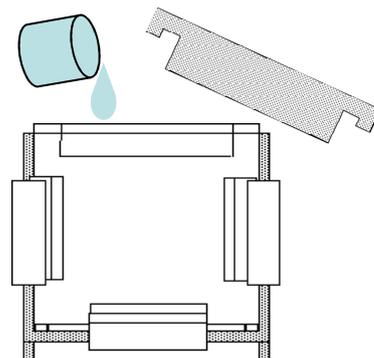
③ アクリルアミド溶液を注ぎ、コームを挿入します。
